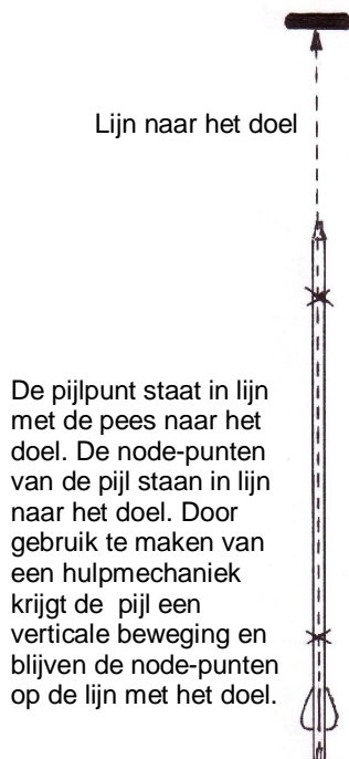
Figuur 5 Compound met hulpmechaniek (CR)
