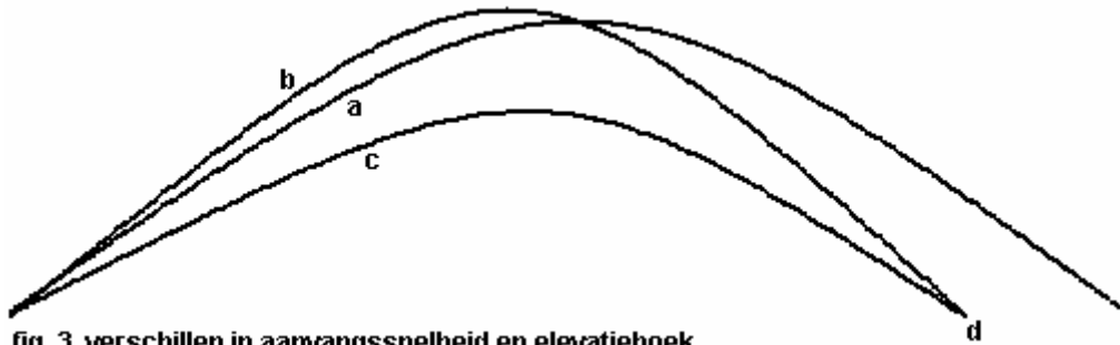
fig. 3 verschillen in aanvangssnelheid en elevatiehoek
